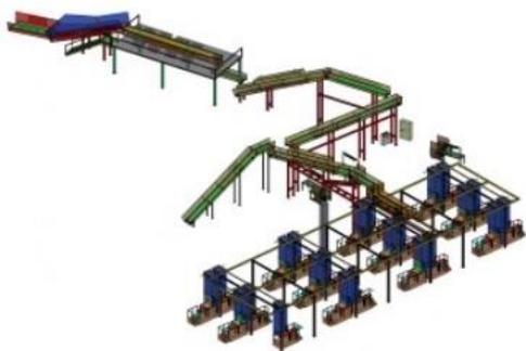
**L'impianto è stato appena rinnovato con la semi-automatizzazione dei processi** che ne consente una maggiore capacità di selezione. **Progettato per essere flessibile** alle esigenze di un mercato in evoluzione e far fronte a qualsiasi necessità legata ad un processo di End of Waste, **ha una capacità di trattamento di 6.000 tonnellate annue, che può salire a 12.000 tonnellate** con l'introduzione di un secondo turno di attività.
